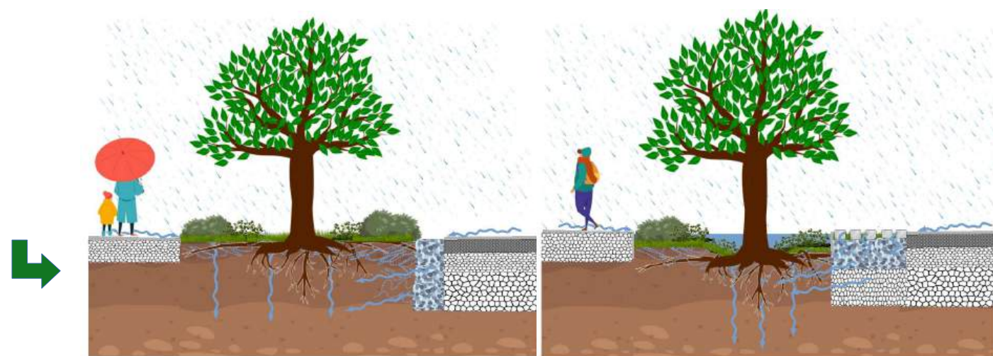
Création de tranchées d'infiltration et suppression des bordures, en bordure de fosse de plantation
