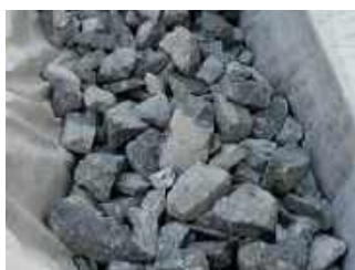
> Gros gravier non traité et concassé de 60 / 100 entouré par un géotextile
